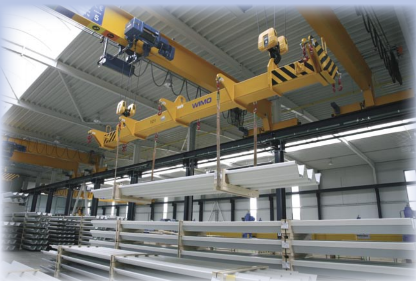
Teleskoptraverse für den Transport von Langgut mit unterschiedlichen Längen.
