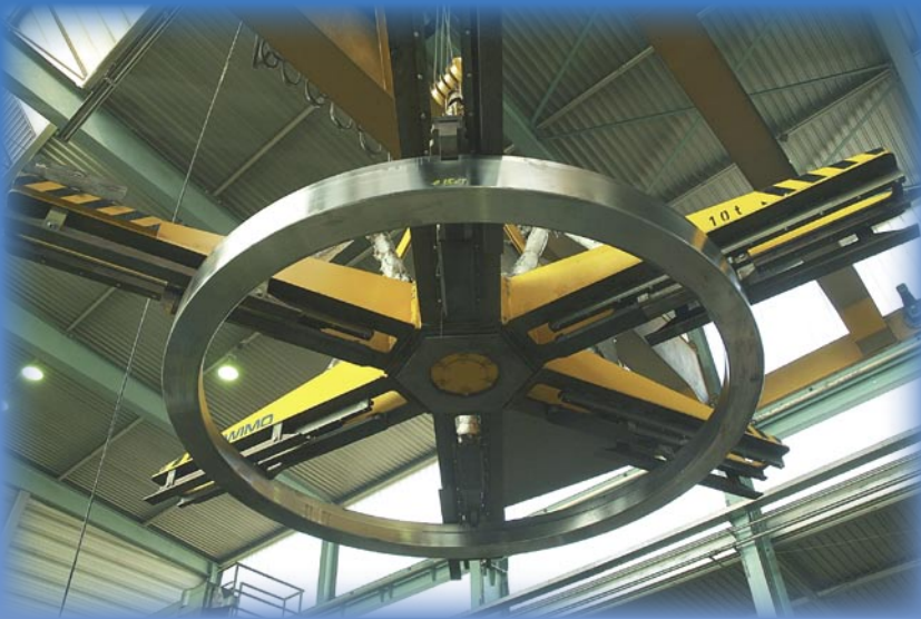
Großringzange für besonders schonenden Transport von Großwälzlagern.
