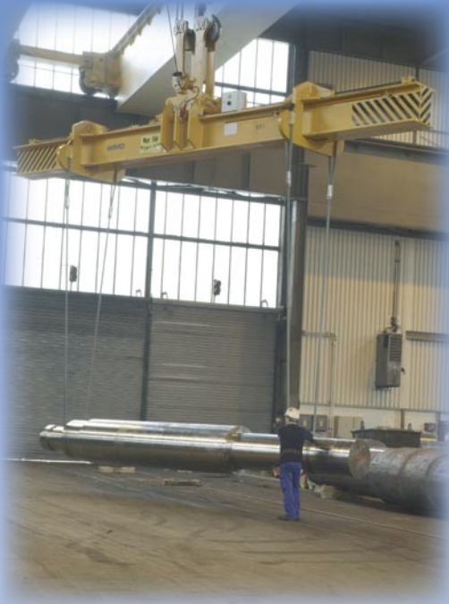
Schwerlasttraverse mit motorisch verstellbaren Anhängerbügeln für Großdrehteile.
